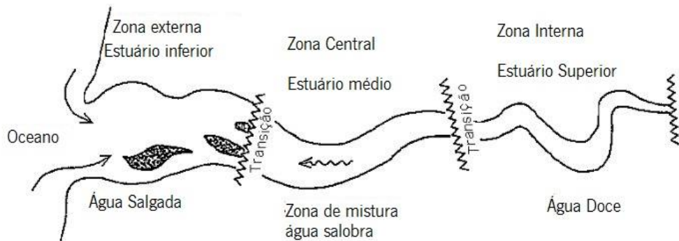
Figura 2 - Estrutura genérica de um estuário. Zona interna/superior – com predomínio de processos fluviais; Zona externa/inferior – dominada pela ação marinha; Zona central/média – onde se misturam processos marinhos e fluviais. Adaptado de Fairbridge (1980).
