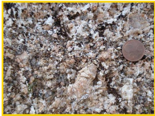
Granito do Gerês em dois locais do afloramento, mostrando o aspecto de núcleos da rocha granítica menos meteorizados, à esquerda e mais alterados, à direita.
