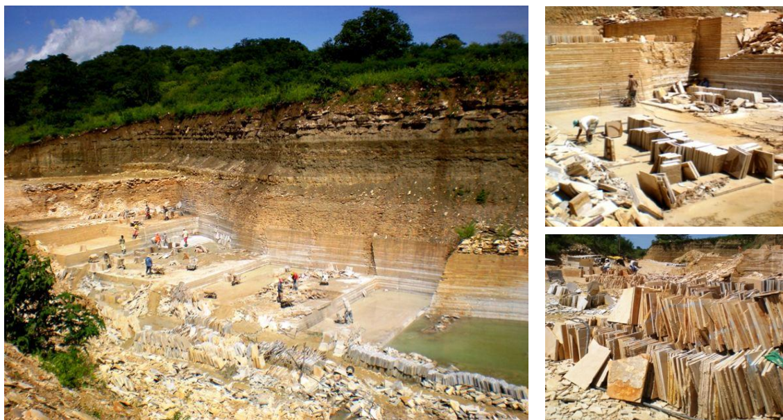
Figura 3.1. Explorações da “Pedra Cariri”, Membro Crato. A- Frente de lavra do calcário laminado em forma de salão, conduzida de modo seletivo a céu aberto; B- pormenor do avanço de frente de lavra, utilização de serras de corte, retirada manual do material e empilhamento; C- organização das lajes de calcário para posterior comercialização.
